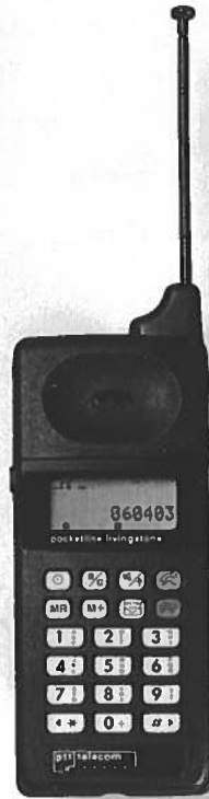
▲ Foto 3 Pocketline Livingstone is geschikt voor de GSM-kaart in creditcard formaat en uiterst compact en licht in gewicht (252 gr. incl. batterij).
